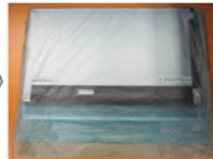
2 nd Panel可視區朝下 & T-CON朝向袋口，放入靜電袋，使2pcs Panel的可視區面對面
